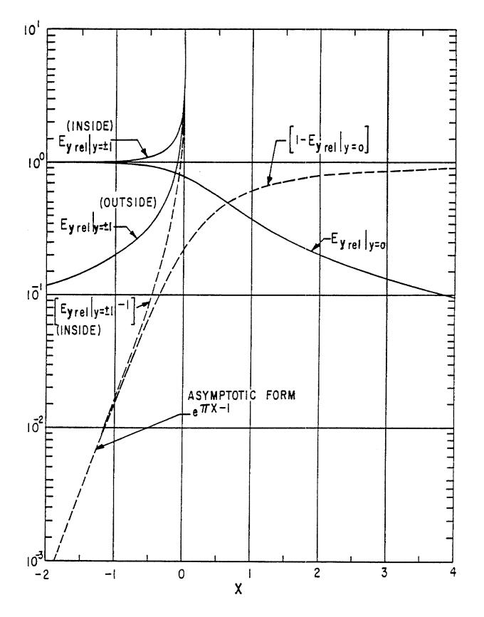
FIGURE 10. NORMALIZED FIELD DISTRIBUTION FOR SEMI-INFINITE, PARALLEL, TWO-PLATE TRANSMISSION LINE
