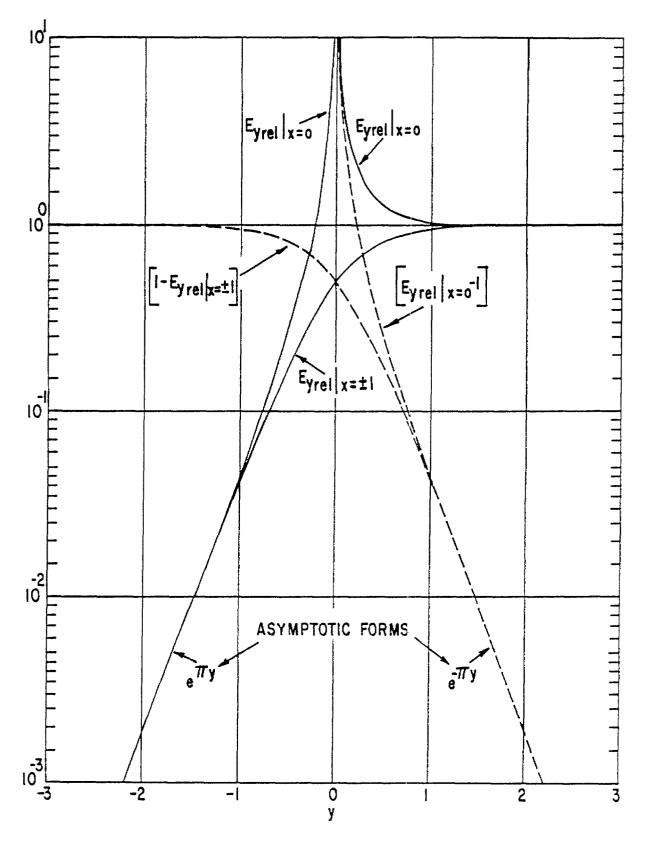
FIGURE 16. NORMALIZED FIELD DISTRIBUTION FOR WIRE GRID TERMINATING UNIFORM FIELD ON ONE SIDE OF GRID
