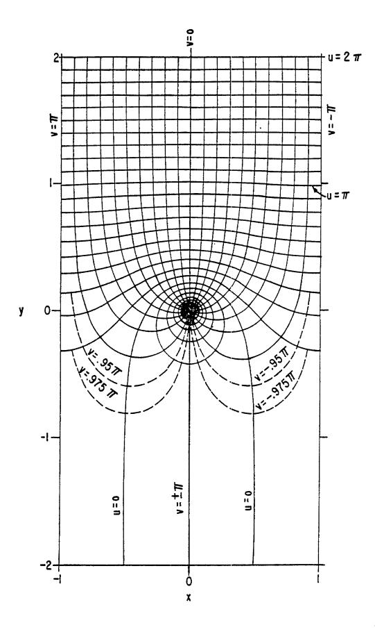
FIGURE 15. WIRE GRID (ONE CELL) TERMINATING UNIFORM FIELD ON ONE SIDE OF GRID
